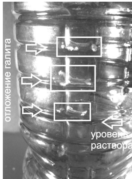
Рис. 2. После опыта на внутренней стенке бутылочки, прилежавшей к теплой трубе, отложилась соль выше уровня раствора.
