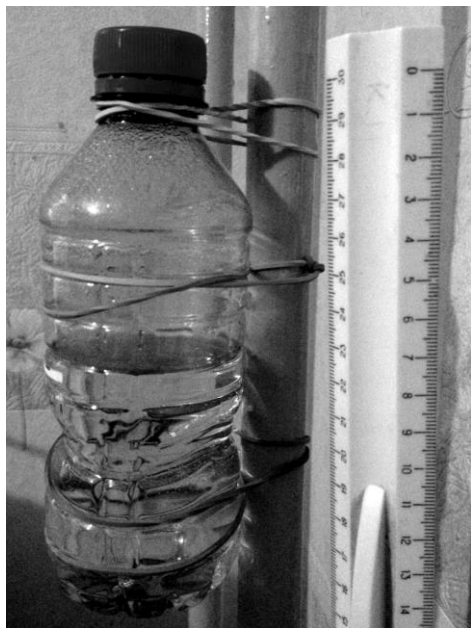
Рис. 1. Бутылочка с раствором NaCl (36 г/кг H 2 O) привязана к трубе водяного отопления с температурой 32 °С на 10 суток.
